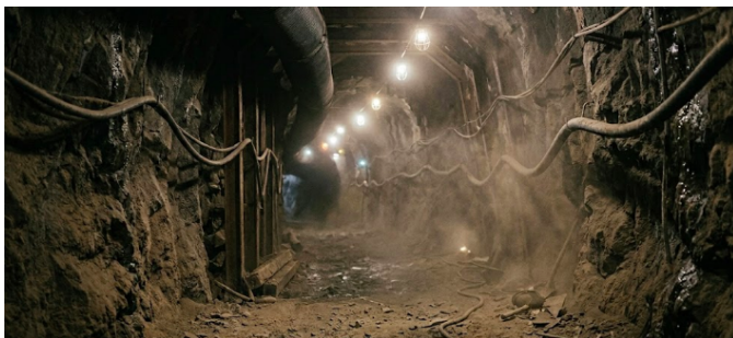
Fig. 3. El polvo en suspensión y la visibilidad reducida pueden atenuar señales ópticas y degradar el desempeño de enlaces que dependen de línea de vista, como FSO o VLC.
