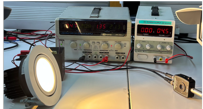
Fig. 1. Montaje experimental VLC con luminaria LED, fuentes de alimentación y receptor óptico utilizado para validar la transmisión mediante luz visible.
