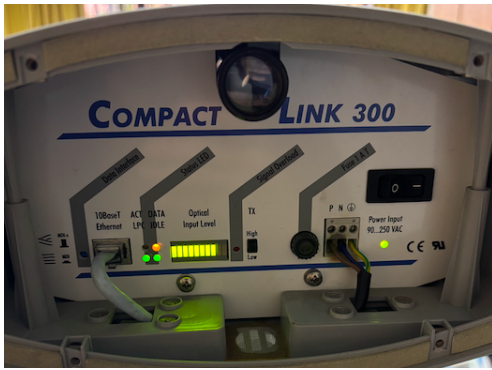
Fig. 2. Transceptor FSO CompactLink 300 utilizado como enlace óptico punto a punto para pruebas de backhaul en espacio libre.
